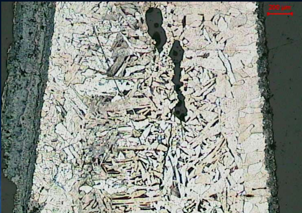
STRUKTURY KRystaliczne MIECZY –MIKROSTRUKTURA FERRYTYCZNO- PERLITYCZNA CRYSTALLINE STRUCTURES OF SWORDS – FERRYTIC- PERLITIC MICROSTRUCTURE
